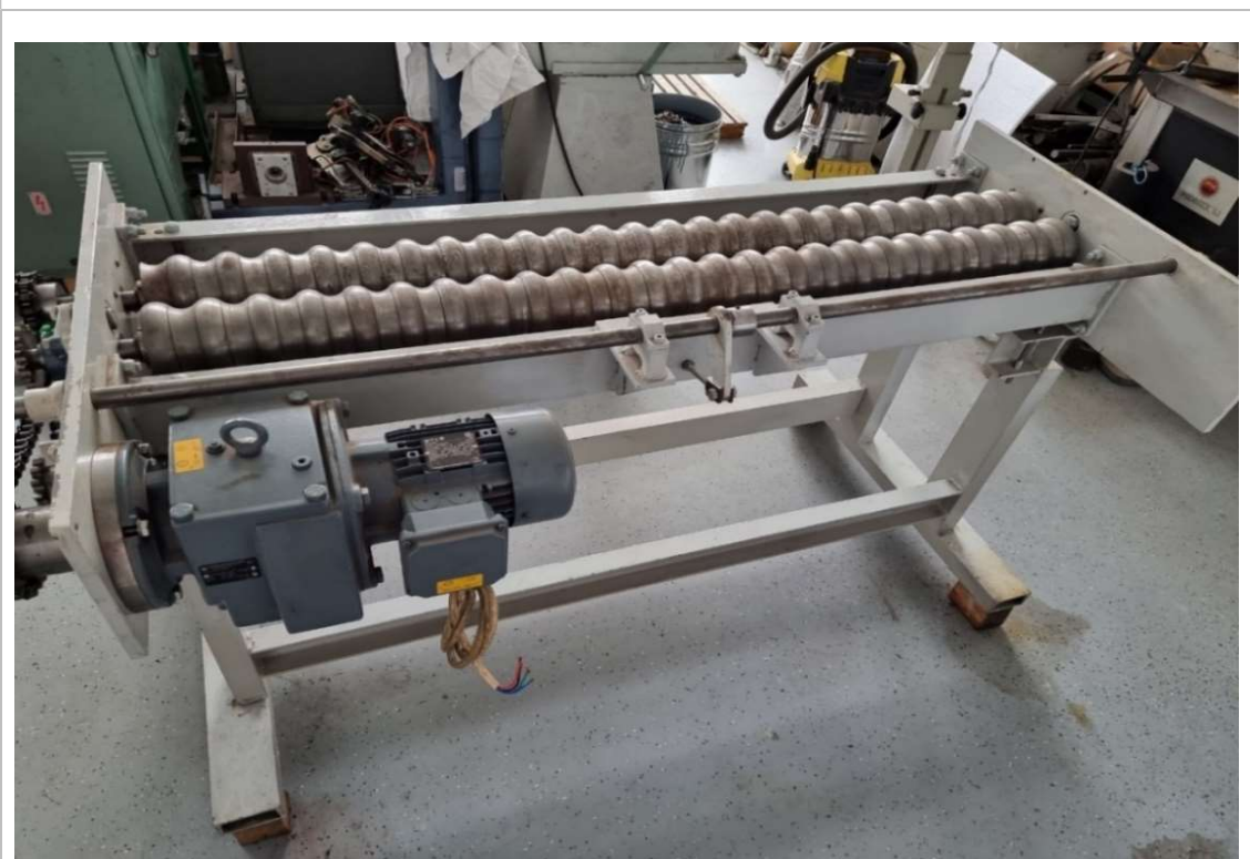
Fig. 4.9 Breaking module prototype
